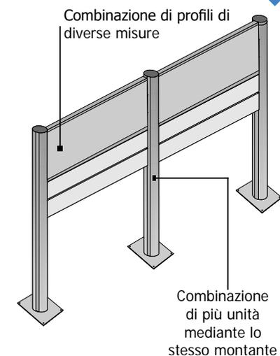
Piantana segnaletica modulare per esterni. Si compone di montanti in alluminio con basi in metallo verniciato e tappi di chiusura in ABS. In alternativa alle basi, è possibile interrare i montanti con apposite staffe da interrimento. I listelli, in alluminio estruso, sono inseriti a scorrimento nei montanti e sono disponibili in varie misure. La grafica è stampata su vinile adesivo laminato.
