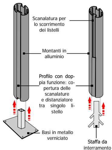
Montanti in alluminio con scanalatura per lo scorrimento dei listelli. Tappi in ABS per la copertura superiore. Possibilità di scegliere tra basi in metallo verniciato con fori per il fissaggio a terra o staffe da interrimento. Profilo con doppia funzione: copertura delle scanalature del montante e distanziatore tra ogni singolo listello.
