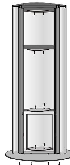
struttura interna in acciaio e metallo verniciato a polveri con distanziali di reazione. Base su richiesta con predisposizione per il fissaggio a pavimento tramite tasselli.
