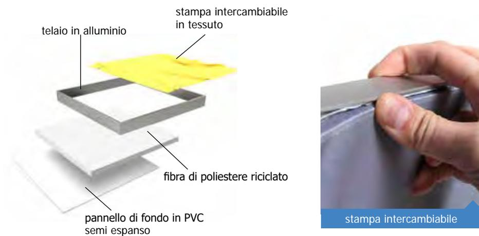
Pannello fonoassorbente da parete con profili in alluminio piatti. Materassino interno fonoassorbente in fibra di poliestere riciclata, spessore 5 cm con grafica intercambiabile. Stampa su tessuto con gommino perimetrale in silicone per il tensionamento.
